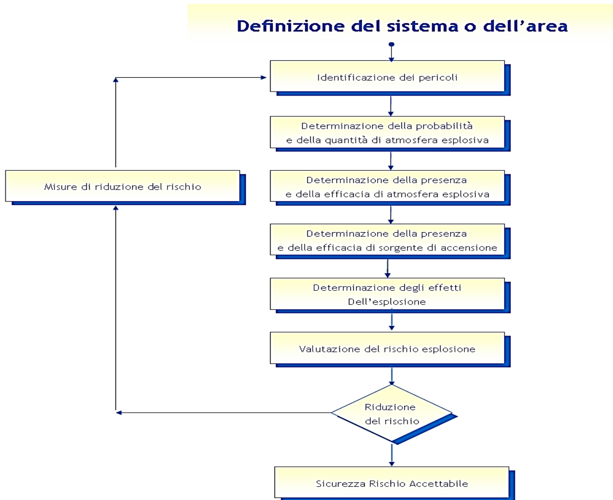
Figura 1 diagramma di flusso per la valutazione del rischio esplosione
